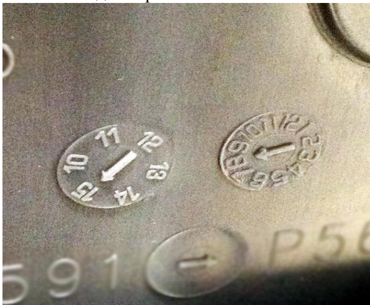
Год и месяц выпуска, выштампованы на пластике.
